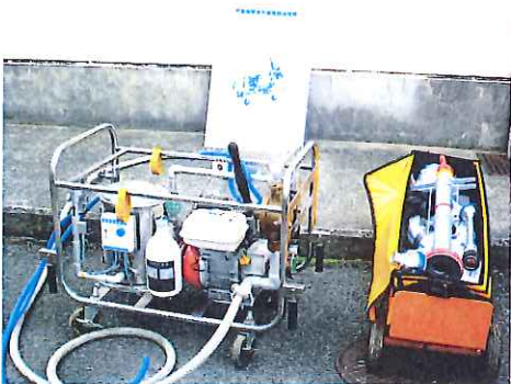
緊急時浄水装置(左)と スタンドパイプ(右)
